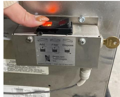
Caja de interruptores
